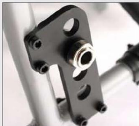
Адаптер для регулировки высоты сиденья и положения оси заднего колеса
