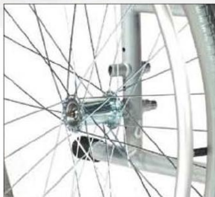
Регулировка высоты сиденья (два варианта)
