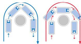
Слева - схема движения каталки с 5-ым колесом. Справа - схема движения обычной каталки.
