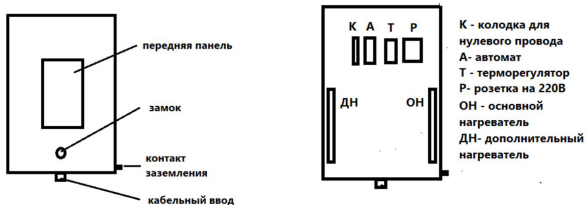
Рис.1 Внешний вид термокорпуса и описание основных элементов при закрытой и открытой двери
