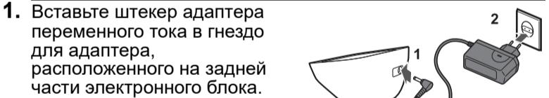
1. Вставьте штекер адаптера переменного тока в гнездо для адаптера, расположенного на задней части электронного блока.
