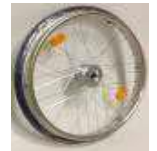
Колесо с барабан. тормозом
