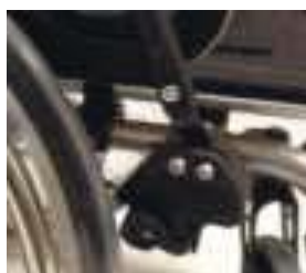
Фиксатор колеса для односторон. управления
