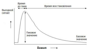
Рисунок 3. Форма изменения сигнала электрохимического датчика
