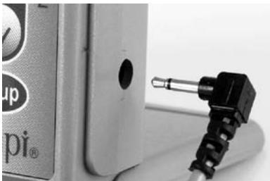
2. Вставьте штекер в гнездо соединительного кабеля (14) аппарата **ARTROMOT®-K1**, и зафиксируйте штекер легким поворотом по часовой стрелке.
