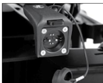
EU043 Слот для зарядного устройства с магнитным механизмом
