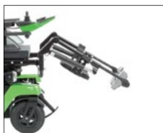
EB004 Электрорегулировка угла наклона подножек (синхронное поднятие подножек)
