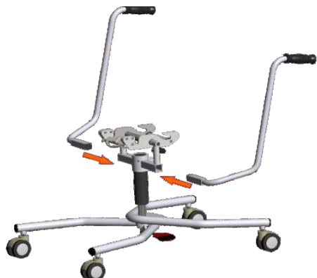
Рис. 5. Поместить ручки в монтажные отверстия крепления сиденья.
