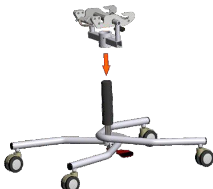
Рис. 2. Установить крепление сиденья на газовой пружине.
