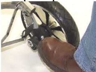
Для того чтобы заблокировать колеса кресла-коляски надавите ногой вниз на рычаг и слегка покатайте кресло-коляску назад или вперед (чтобы стопорный штифт зафиксировался в тормозном диске). Не применяйте чрезмерных усилий, при блокировке колес, т.к. может произойти повреждение быстросъемной системы колес!
