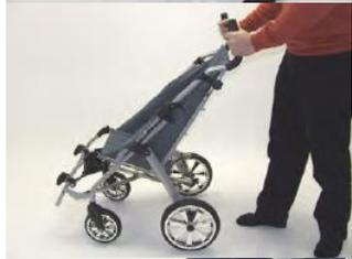
Тяните ручки для толкания назад до тех пор, пока не заблокируется специальный защитный фиксатор механизма раскладывания кресла-коляски.
