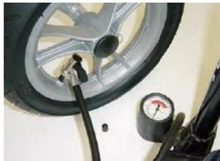
Если кресло-коляска оборудовано колесами с пневматическими шинами, то перед эксплуатацией кресла-коляски необходимо проверить давление в шинах.
