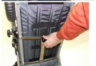
Надавите на фиксатор складывания спинки до упора.
