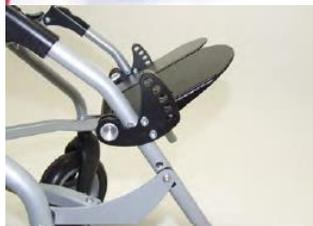
Минимальная длина подножки (кронштейн опоры для стоп установлен в положение «вверх»).
