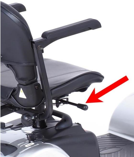
Чтобы повернуть сиденье изделия вбок для комфортной посадки и высадки, потяните за рычаг фиксатора справа под сиденьем.
