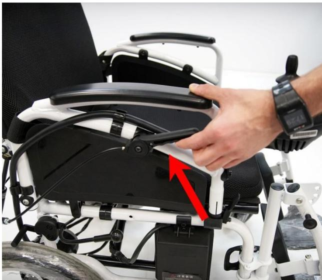
Для того чтобы опустить спинку в лежачее положение нажмите рукоятку фиксатора и откиньте спинку назад. Ее можно зафиксировать в любом удобном положении.
