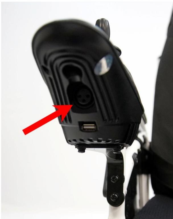
Зарядка коляски производится подключением зарядного устройства к джойстику.
