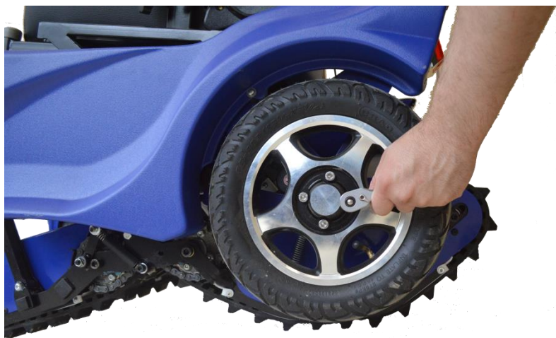
Рис. 12.1. Подтягивание винтов крепления ведущих колес
