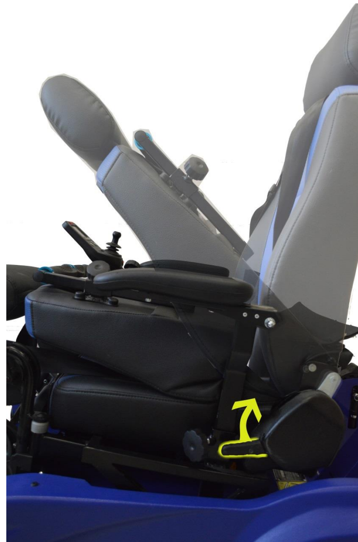
Рис. 5.1. Перевод спинки в транспортировочное положение
