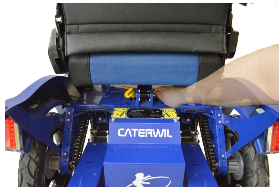
Рис. 7.13. Рычаги перевода коляски в режим холостого хода
