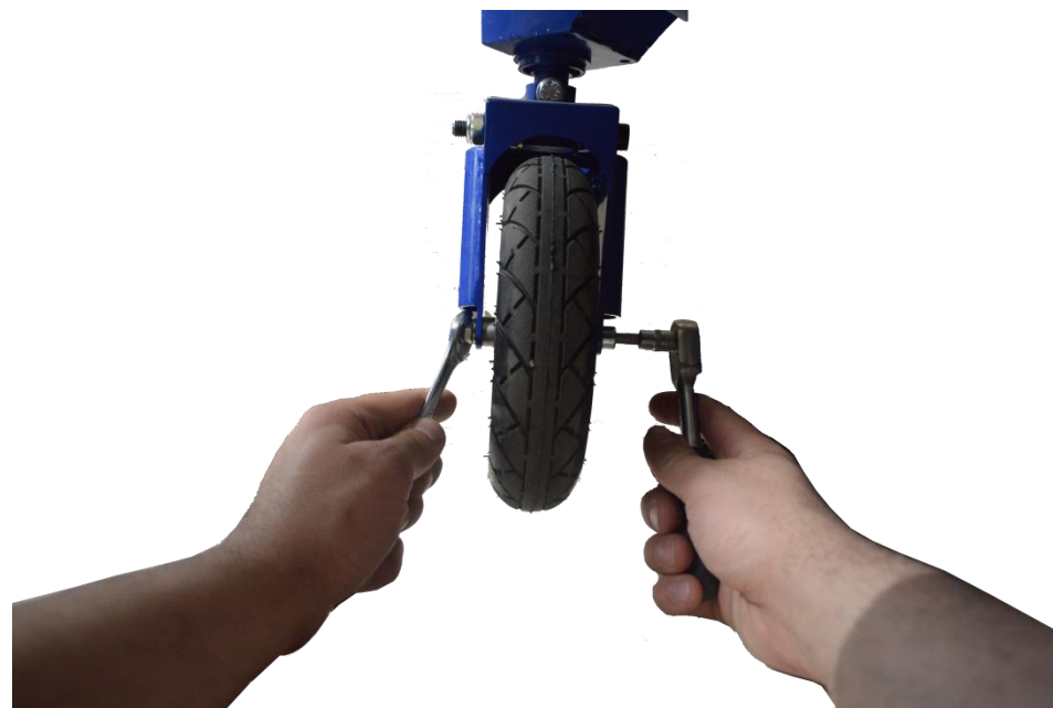
Рис. 12.2. Подтягивание оси ведомого колеса
