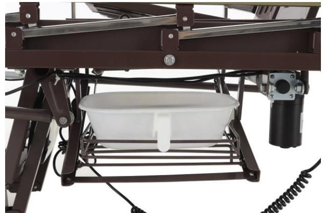
Б) При необходимости отрегулируйте ход туалетной секции: извлеките шплинт на конце тяги туалетной секции, выведите тягу из зацепления с пластиной поворотной трубы и вкручивайте или выкручивайте её для регулировки плотного закрытия туалетной секции. Добавившись нужного положения, снова вставьте конец тяги в отверстие пластины поворотной трубы и зашплинтуйте его.
