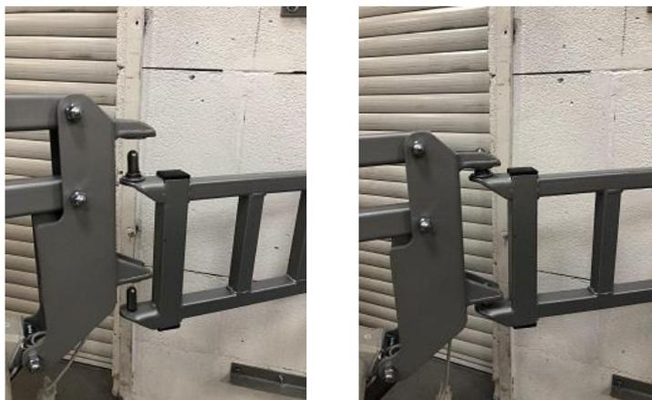
**Шаг 5: Установка подъемного устройства на стрелу подъемника**
